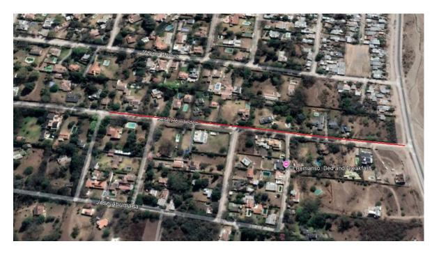
La pavimentación propuesta es del tipo articulado de 8 cm de espesor, abarcando una superficie de 3036 m2.
